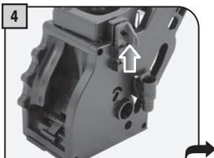
Ist das nicht der Fall: Sicherstellen, dass sich alle Teile in der richtigen Stellung befinden. Der gezeigte Haken muss sich in der korrekten Position befinden. Um dies zu überprüfen, wird die Taste "PUSH" fest gedrückt.
